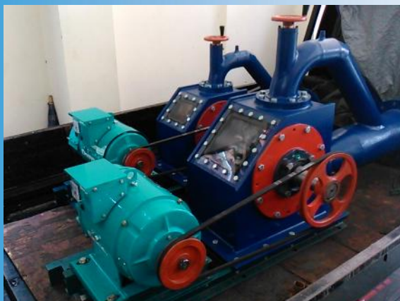
Menggunakan turbin Pelton untuk head tinggi > 50 m
